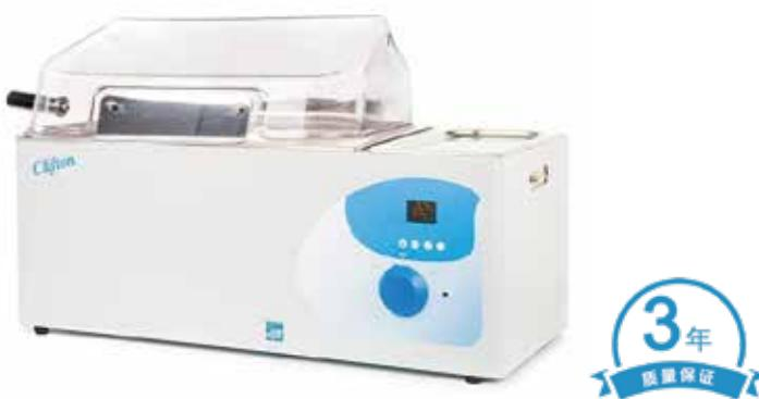
Clifton® NE5系列恒温振荡水浴，集恒温和振荡功能于一体，具有精密的温度控制系统和优越的往复式振荡模式，内置不锈钢穿孔托盘，可选配多种实验夹具，用于固定不同容器，安装、拆卸方便。浴槽容量10L/28L两种可选，运行安静平稳，性能稳定可靠。外壳表面采用独特的抗菌技术，可有效抑制细菌生长且易于清洁，一体成型的优质不锈钢内槽，高精度微电脑PID温度控制器和特殊硅橡胶SCS加热技术，加热模块隐藏覆盖于浴槽外部，方便清洁槽内卫生，易于维护，实现槽内空间最大化，主要适用于各大中院校、医疗、石油化工、卫生防疫、环境监测等科研部门生物、生化、细胞、菌种等各种液态、固态化合物的恒温振荡培养。
